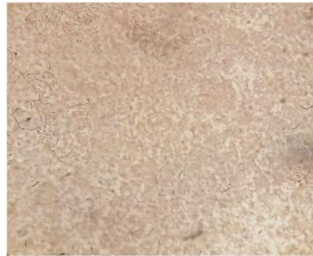
Gambar 8. Struktur mikro Benda Uji di Annealing lalu Hardening 840°C selama 15 menit didinginkan di dalam oli SAE 15 (Etsa Nital 3%, Pembesaran 400X)
