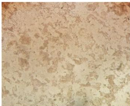
Gambar 6. Struktur mikro Benda Uji yang mendapat perlakuan Annealing pada 820°C selama 20 menit. (Etsa Nital 3 %, Pembesaran 400X)
