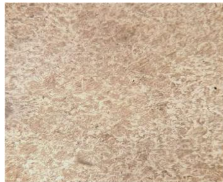
Gambar 9. Struktur mikro Benda Uji di Annealing lalu Hardening 840°C selama 15 menit didinginkan di dalam oli SAE 20. (Etsa Nital 3% Pembesaran 400X)
