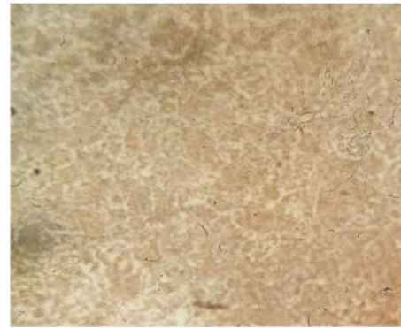
Gambar 7. Struktur mikro Benda Uji di Annealing lalu Hardening 840°C selama 15 menit didinginkan di dalam oli SAE 10. (Etsa Nital 3% Pembesaran 400X)
