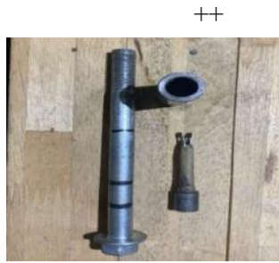
Gambar 7. Silinder Utama dan Torak Utama
