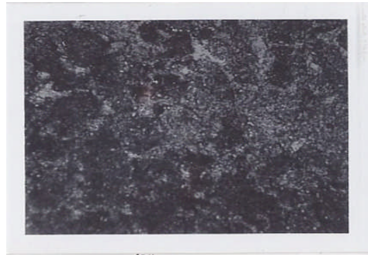
Gambar 5 : Benda uji asal (Etsa 5 % nital, Pembesaran 400 X)
