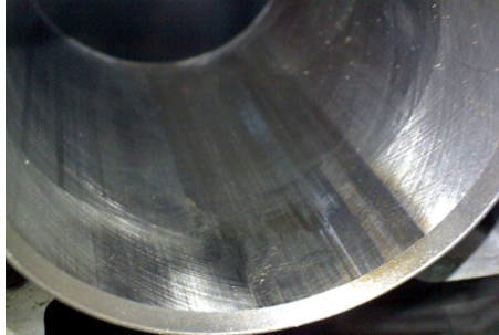
Gambar 1. Liner Motor yang Mengalami Kerusakan Akibat Kesalahan Pemasangan
