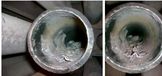
Gambar 8. Deposit di dalam Tube
