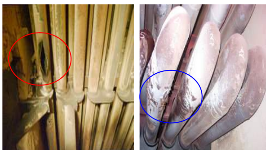
Gambar 3. Koil Mixed Feed Yang Pecah
