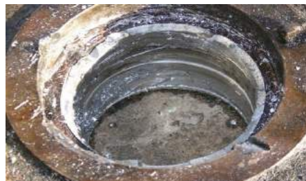
Gambar 2. Linear Poros yang aus karena kurangnya perawatan pelumas
