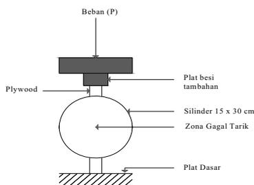
Gambar 2.2 Pemodelan Kuat Tarik Belah (*Splitting Test*)
