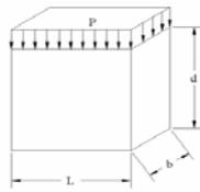
Gambar 2.1 Pemodelan Pembebanan Kuat Tekan Beton
