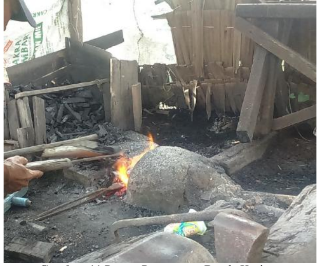
Gambar 11 Proses Penempaan Benda Kerja
