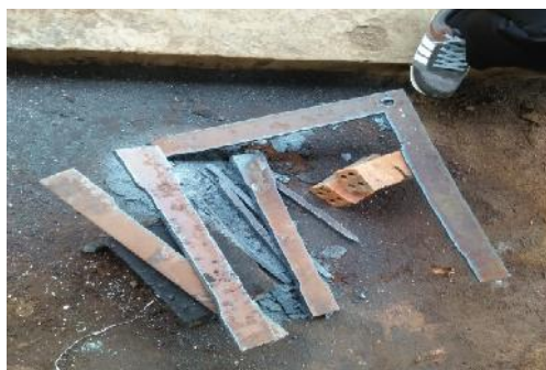
Gambar 4. Proses pemotongan spesimen dari lembar/ sheet metal
