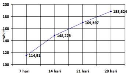
Gambar 3 Kuat tekan beton menggunakan air PAM
