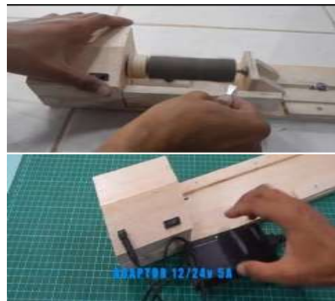
Gambar 7 Mesin bubut mini dari kayu siap beroperasi
