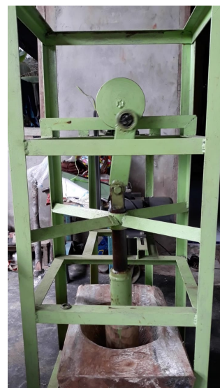
Gambar 5. Alat penumbuk beras aruk
