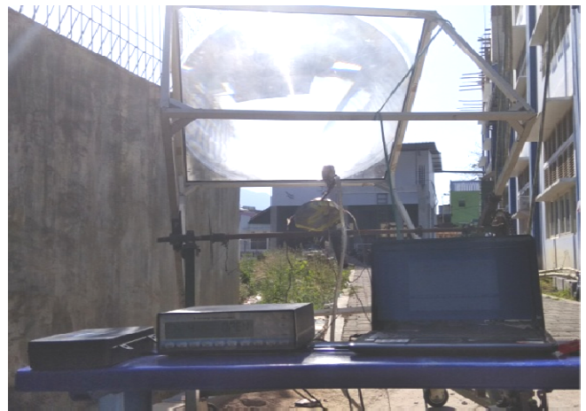
Gambar 5. Konstruksi prototipe alat purifikasi air tenaga surya
